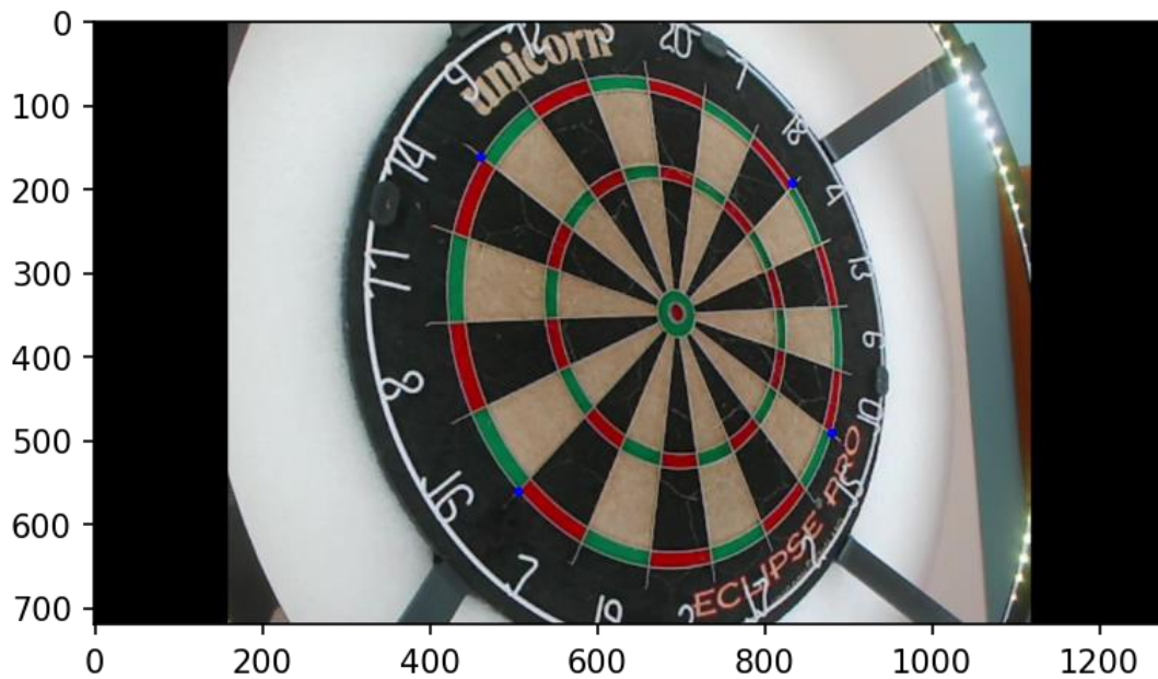
Obr. 14: Automaticky vybrané priesečníky na transformáciu
